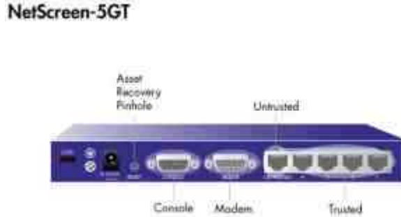
Şekil 1.4: Netscreen-5GT Firewall Cihazı
